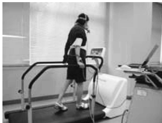
図2. 呼気ガス分析測定の様子
