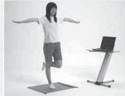
圧力分布シート1枚(600×600mm)で、直立姿勢時における圧力分布計測ができます。なお各種ソフトプログラムをご用意しています。
