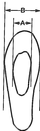
図2. ボール幅(B)とアーチ・サポート幅(A). A: アーチ・サポート幅, B: ボール幅
