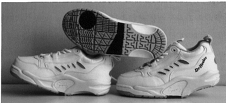
写真1. 実験に使用した靴底が3面の立体構造からなる特殊シューズ
