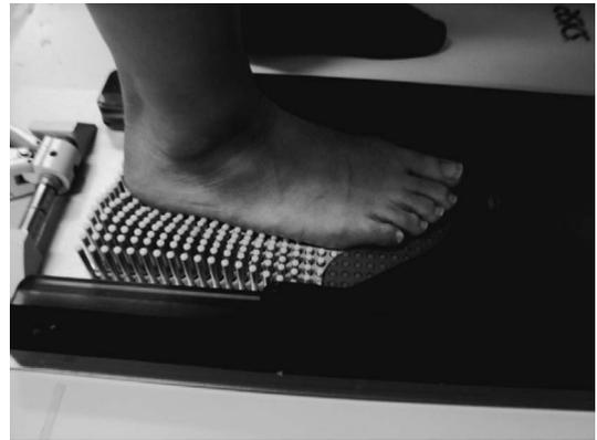
図 1-a. デジタイザーにて足底形状を測定する.
