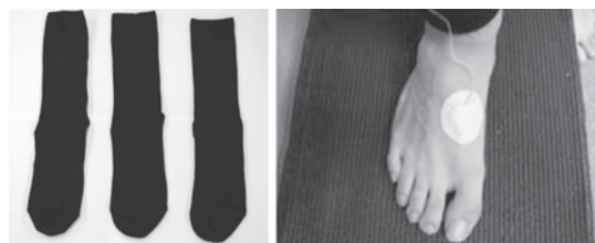
図 1. 実験試料と圧力センサの装着位置 (左図：左から試料 A, 試料 B, 試料 C)
