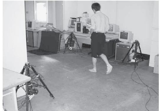
図2. 実験系全体. 4台のCCDカメラで歩行時における、足部に貼付したマーカ-の3次元座標を計測した。
