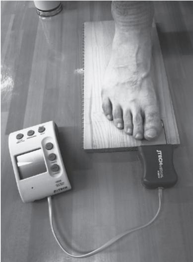
図1. ハンドヘルドダイナモメータによる母趾圧迫力測定
