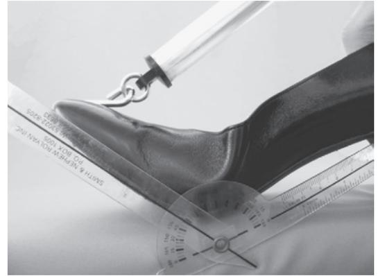
図2. 靴の屈曲硬度測定
