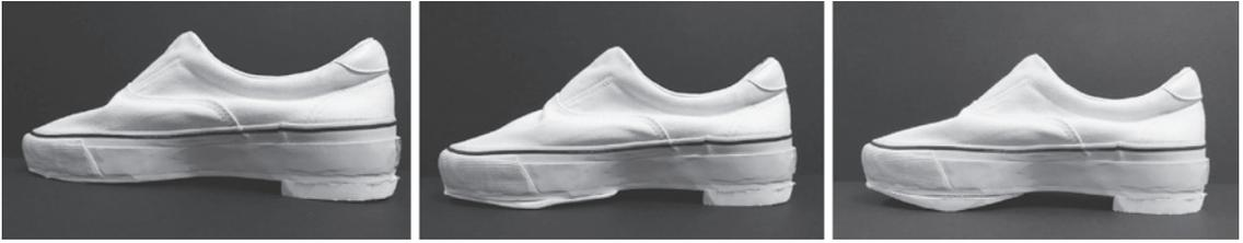
図1. 実験靴（ロッカーバーの高さ 左：0mm 中：4mm 右：8mm）
