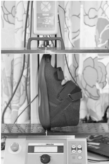
図1. 市販の荷重・変位測定器に一部特殊装置を加えた機器を使用した。履物を足尖から踵まで圧迫力のかかる方向と平行になるように測定装置に設置固定して、低速度で荷重した。経時的にデータをコンピューターに取り込み処理した。
