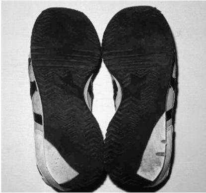
図2. 踵後外側が著明に摩耗してミッドソールが露出したシューズ
