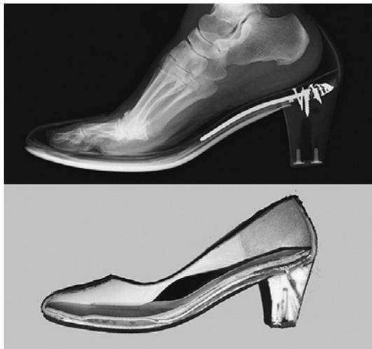
図2. 試作パンプスを履いた足のX線写真とパンプスの縦断構造
