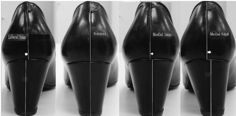
図 1. 実験靴（外側 3mm, 踵骨中央, 内側 3mm, 内側 6mm の 4 種類の形状）
