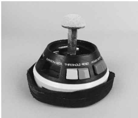
図 2. 徒手筋力測定評価器 (圧子先端をコルクゴム製の半球形状に改造した)
