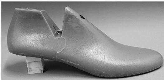
図 4. 部分修正した靴型
