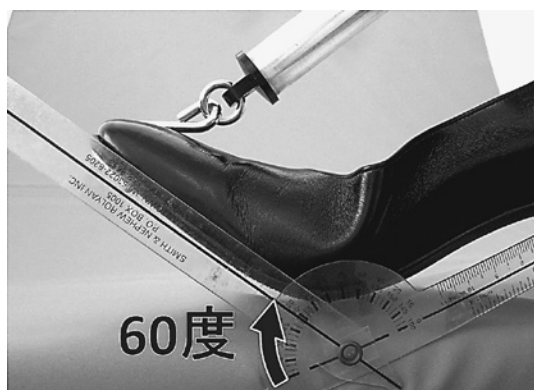
図5. 靴のボール部を60度に背屈させ屈曲硬度を計測した
