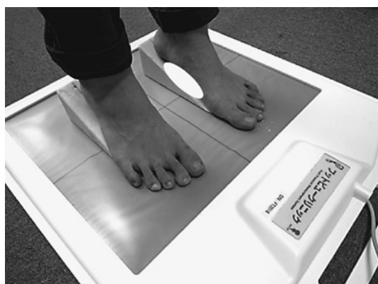
図2. 足圧分布測定器上で段階的に踵を上げ、さらに内側縦アーチパッド高を変化させた
