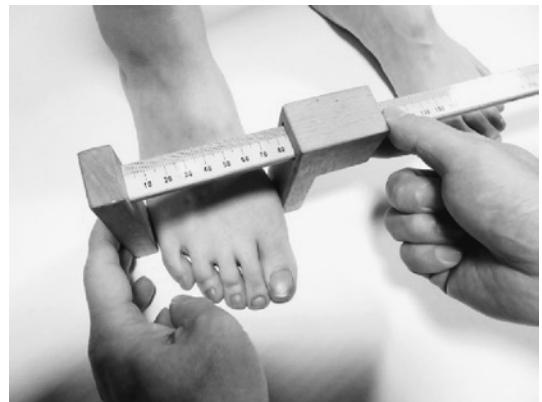
図4. 足幅荷重位計測
