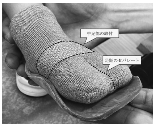
図2. 作製した靴下の外観と機能
