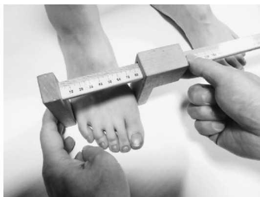
図 4. 足幅荷重位計測
